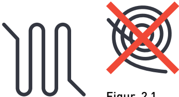
Figur 2.1 Rekommenderad hantering av alltför lång kabellängd.
