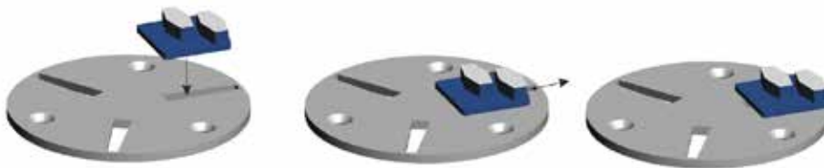
Figur 4.3 Montering av verktyg på Scan-On-fästskivor.
