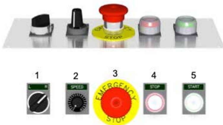
Figur 4.2 Kontrollpanel för Scanmaskin 450NS.
