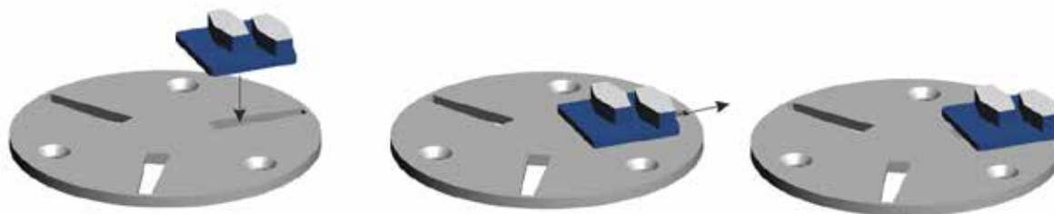
Figur 43 Hur man fäster slipsegmenten på Scan-On-fästskivan
